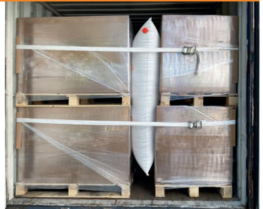
Existe aussi avec une fermeture par boucle de serrage 2T, mise en tension avec un tendeur manuel à conserver.
