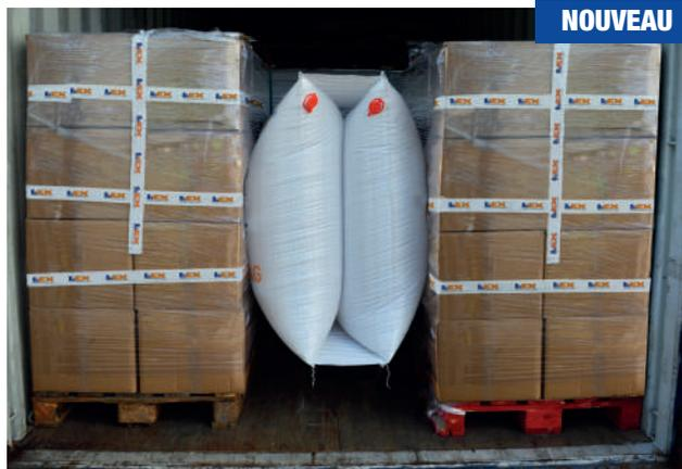
Le coussin de calage DUAL AIRGOBAG est la solution la plus adaptée pour **combler les creux de plus de 40 cm de large jusqu'à 85 cm** entre les palettes de marchandises à l'intérieur des conteneurs, wagons ou camions.
